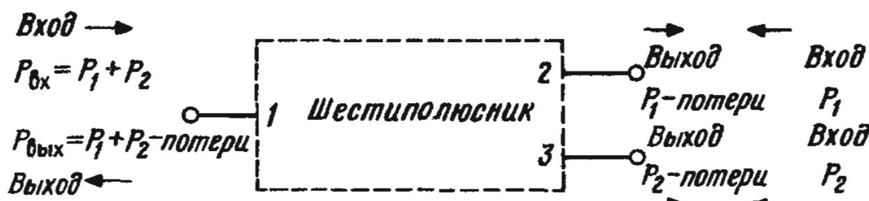
Рис. 5.38. Представление делителя (сумматора) мощности в виде шестиполюсника
